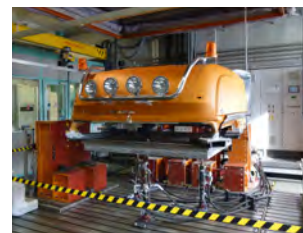
Banco di prova idropulsante per la simulazione di buche e strade dissestate.
