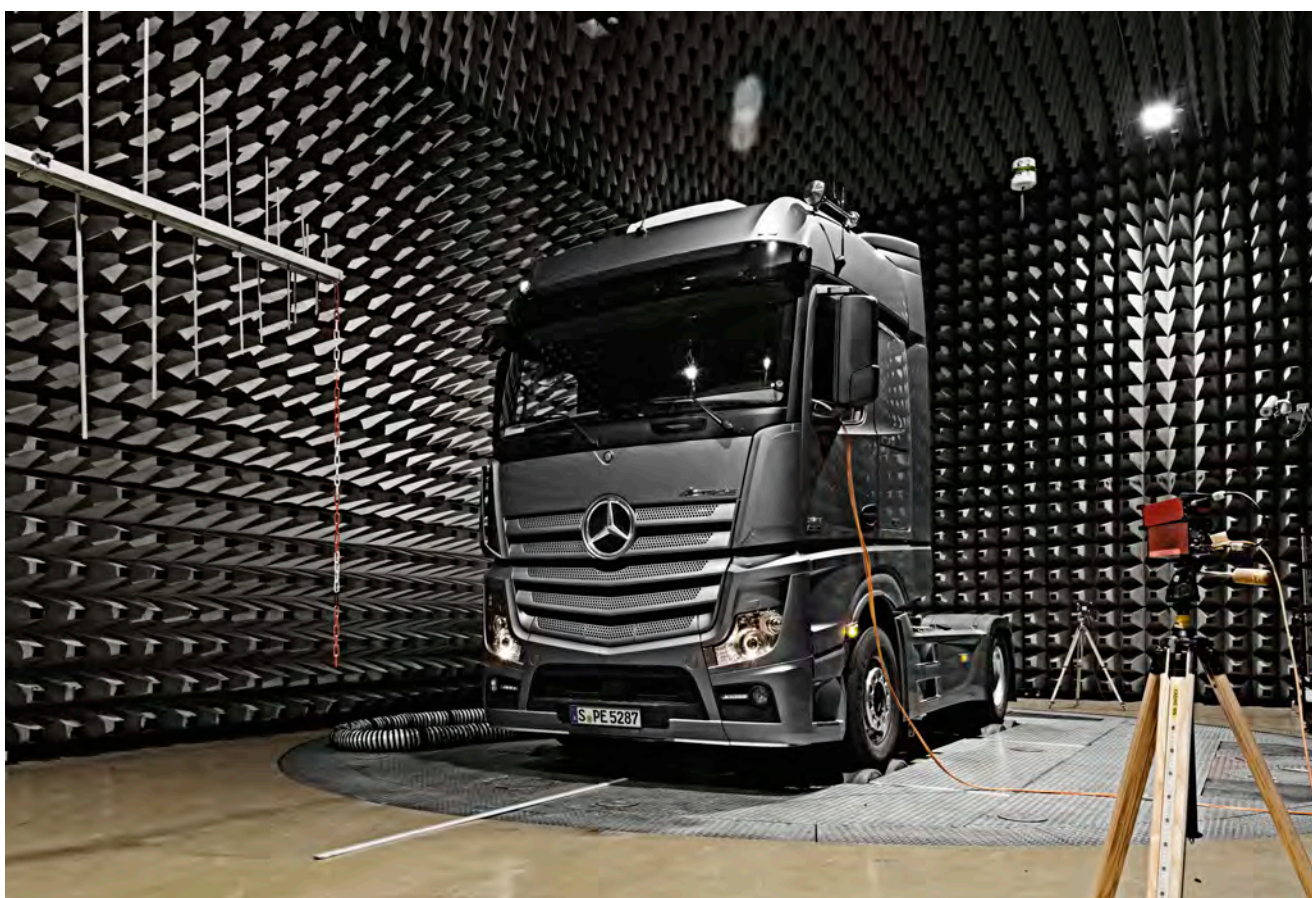
Verifica della compatibilità elettromagnetica in un padiglione appositamente schermato dalle interferenze elettromagnetiche esterne.
