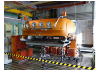
Banco di prova idropulsante per la simulazione di buche e strade dissestate.
