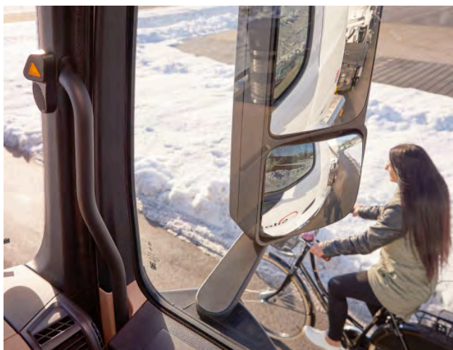
Qualora sussista un pericolo di collisione imminente, l'assistente avverte il conducente con un allarme
