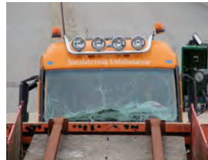
Sollecitazioni limite: il crash-test per la staffa di supporto per fari sul tetto.
