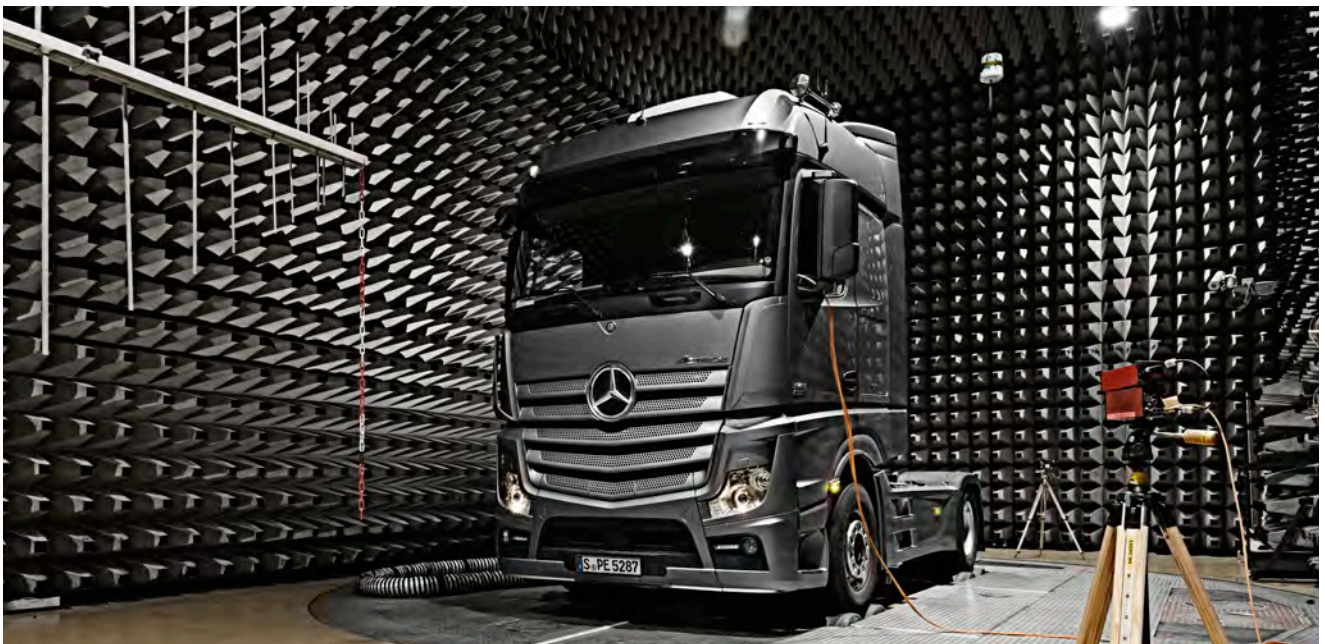
Verifica della compatibilità elettromagnetica in un padiglione appositamente schermato dalle interferenze elettromagnetiche esterne.
